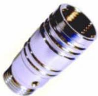
Este mecanismo se coloca fácilmente entre la grifería de ducha y el flexo. Limita el paso del agua en un 50%, pero gracias a la mezcla de agua con aire consigue que aumente la presión y que no disminuya la calidad de servicio.
